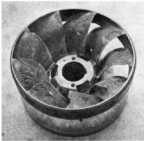
Roue de turbine Francis érodée par cavitation
