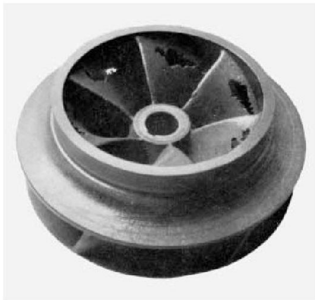
Figure IV.9.b : Dégâts par cavitation sur des roues de pompes et de turbines
