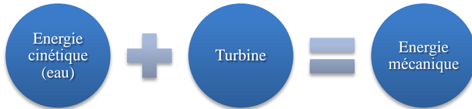
Figure III.3 : Transformation de l'énergie cinétique de l'eau par une turbine en énergie mécanique
