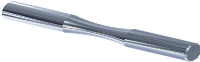
Figure 2.12 : Vue 3D de l'éprouvette de l'essai de fatigue. [7]
