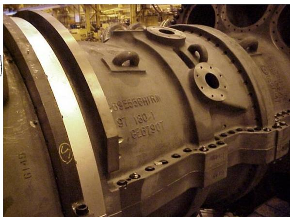
**Figure II.13: Corps du compresseur.**
