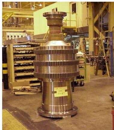
**Figure II.24:** Rotor Turbine.
