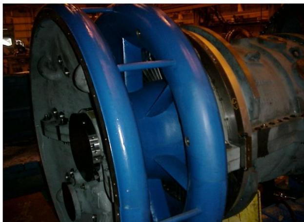
**Figure II.11:** Corps d'admission.**• Aubes orientables à l'entrée du compresseur :**
