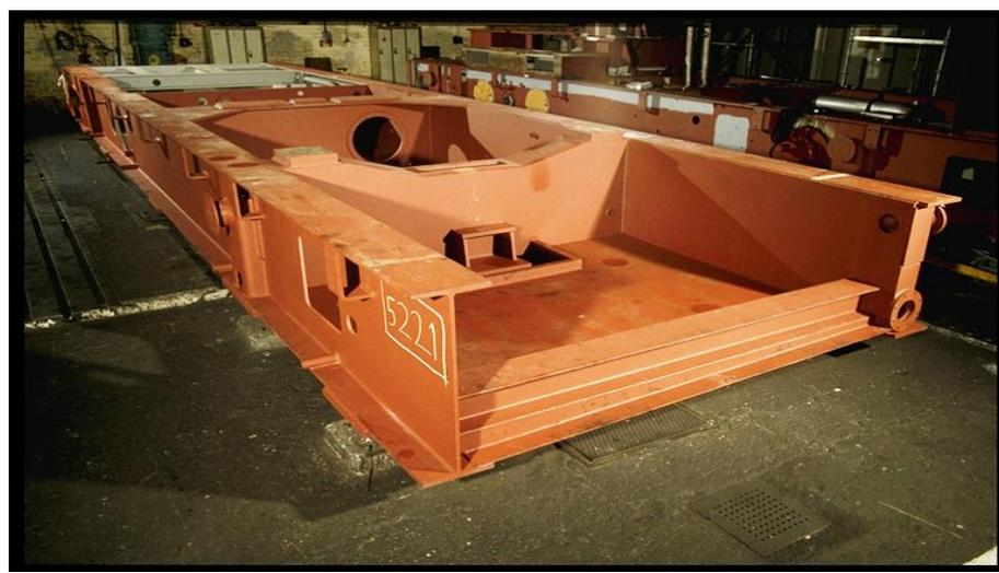
**Figure II.4:** Socle turbine.
