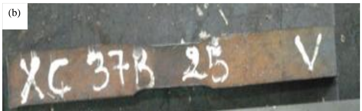
Figure III.2 : les éprouvette, (a) dimension d'éprouvette, (b) photo d'éprouvette de traction.
