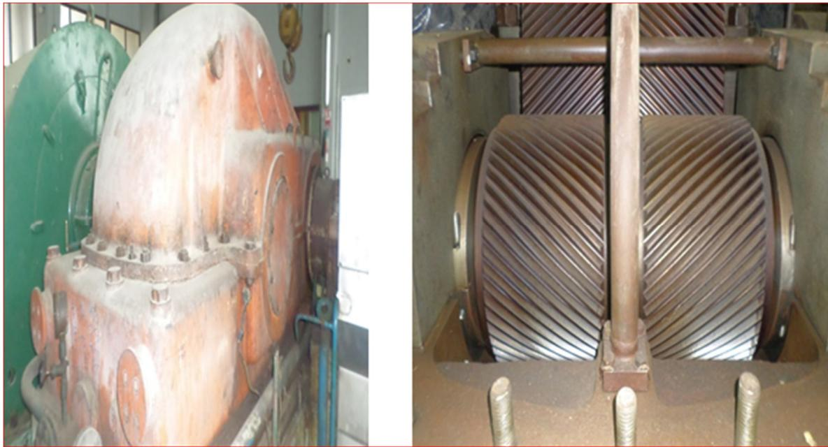
*Figure 4 : Réducteur à engrenage en double « SIEMENS T80 »*
