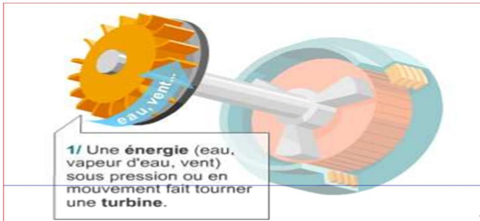
Figure 13 : Transforme l'énergie mécanique en électricité Etape 1
