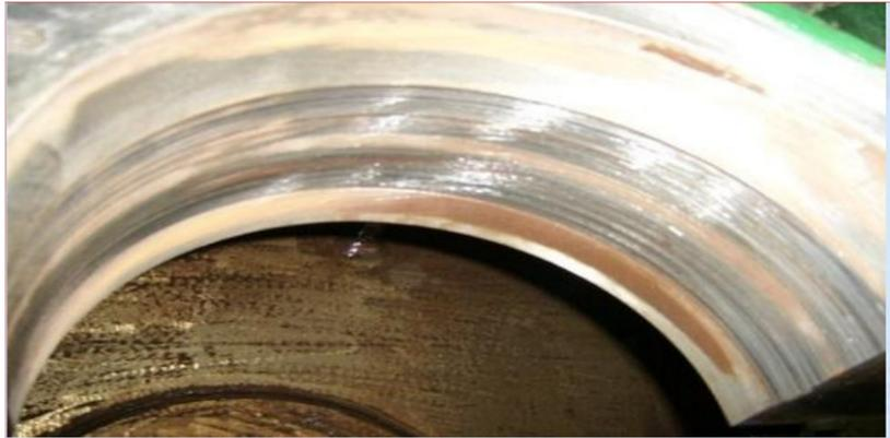
*Figure 49: Usure de palier*
