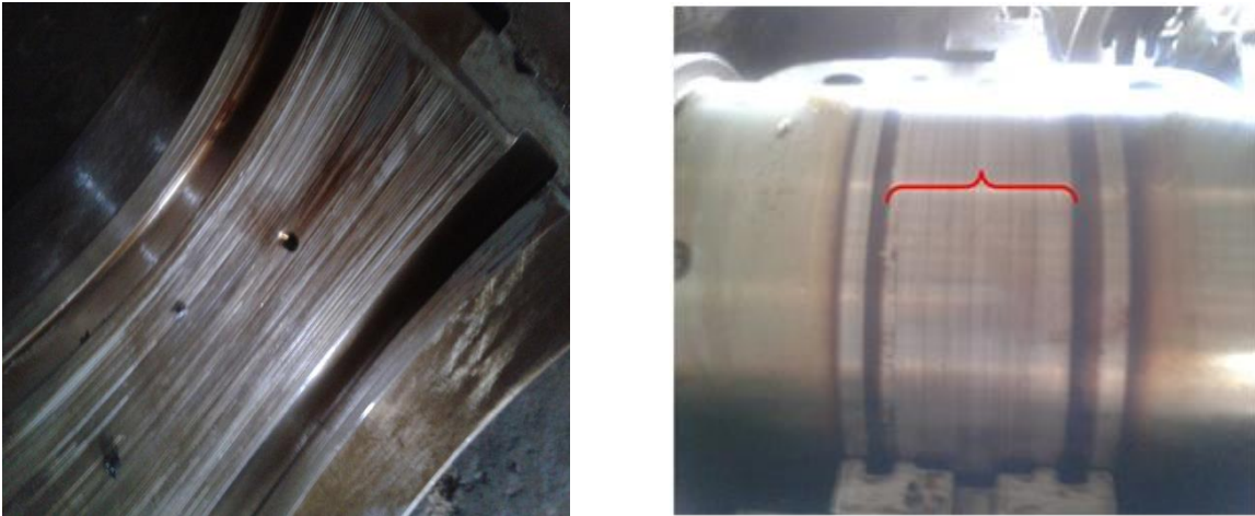
Figure IV.1: Usure du palier du turbocompresseur
