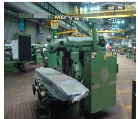
Fig. I.5. Fraisage universel à CNC
