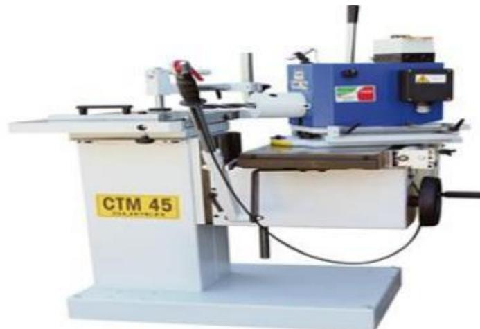
Figure. II.6. Mortaiseuse
