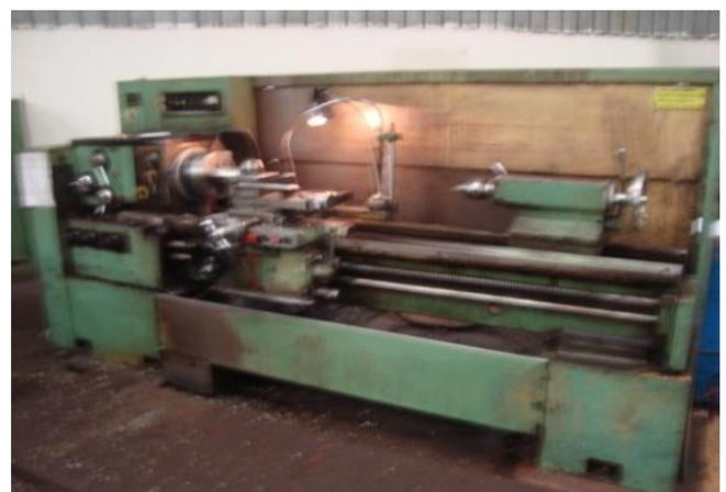
**Fig. I.9.** Tournage parallèle (//) conventionnel àCNC **Fig. I.10.** Tour Parallèle 16D20
