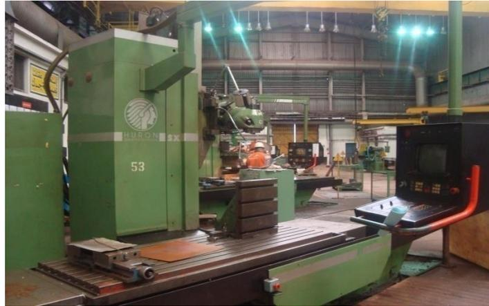
**Figure. II.11.** Fraisage commande numérique
