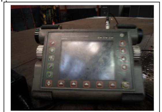
Fig 27 : Appareil de Détection ultrason utilisé au niveau de AMA
