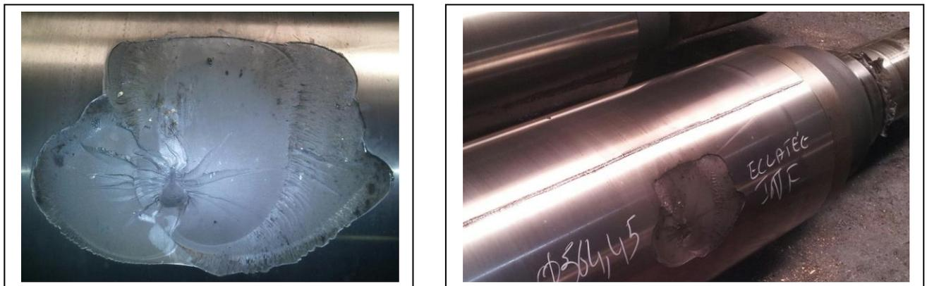
Fig 39 : Photos prises de l'incident sur cylindres de travail du 02/04/2014
