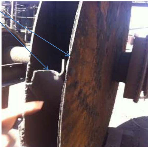
Fig.IV.3 : Usure de turbine
