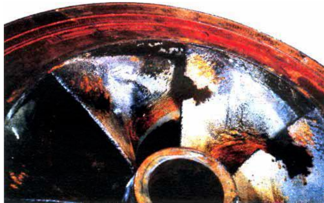
Figure IV.9: Érosion par cavitation d'une roue de pompe centrifuge
