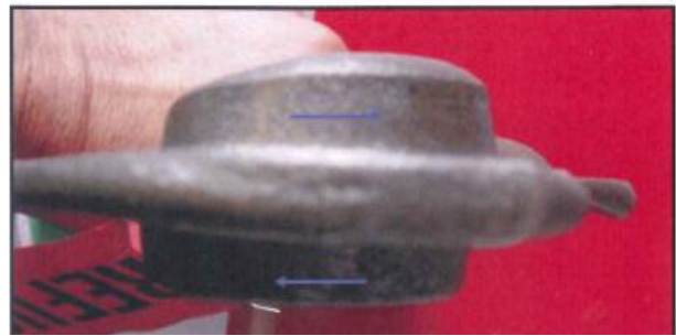
Figure 2.7 : Principe de caractérisation des défauts de forge [5]
