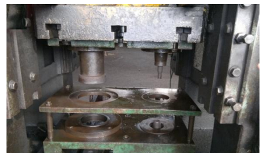
Figure 3.6 : Vue avant des outils sur la presse: a) Ebarbage et b) Poinçonnage [12, 15]
