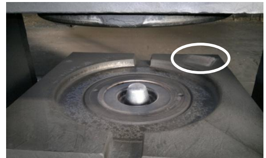
Figure 3.4 : Insert inférieur avec trace d'usure de l'empreinte de la préforme [12, 15]
