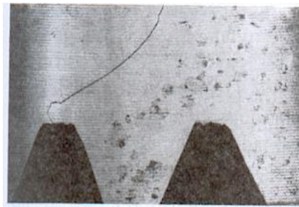
Figure 4.31 : Fissuration au pied de la dent
