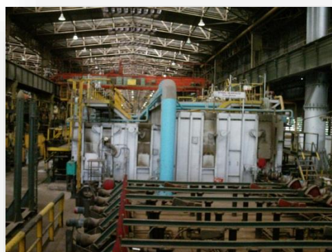
Figure 17 : La table de classement des tubes
