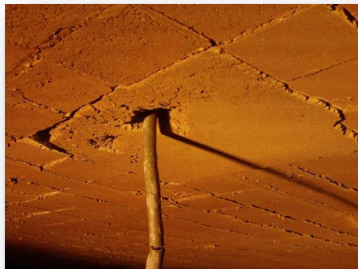
Figure 24: Capteur de température (intérieur du four)
