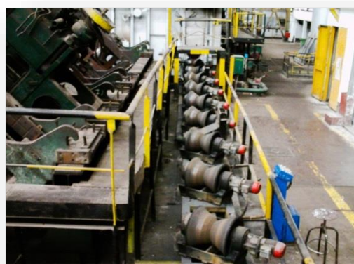
Figure 18 : Ligne de rouleaux inclinés
