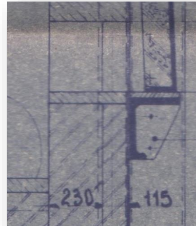
Figure 55: Représentation de l'épaisseur et la composition des murs du four de trempe
