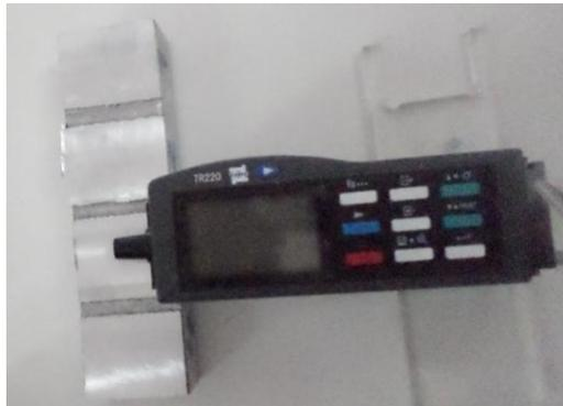
Figure n° 8 : Rugosimètre
