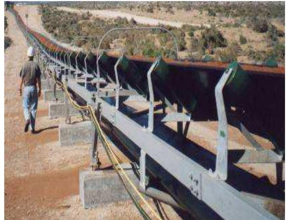
**Figure 11 : Images des convoyeurs à bande**
