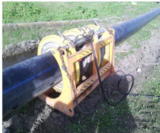
*Figure I.10: Machine à souder bout à bout*
