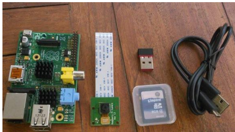
Figure V.1 : Equipements nécessaires à la transmission vidéo
