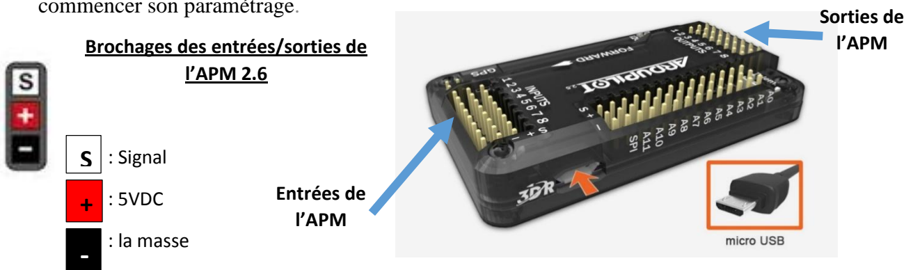
Figure IV.4 : Connexion de l'Ardupilot APM 2.6 avec un PC
