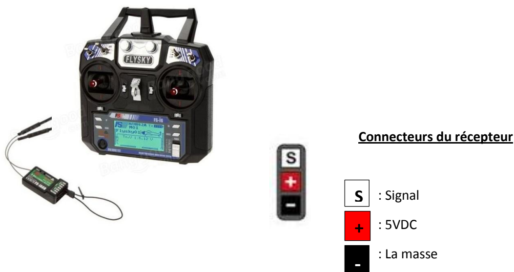
Figure IV.19 : Appairage de la télécommande RC au récepteur
