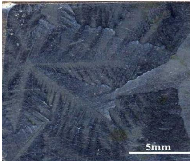
Fig. I.3: Structure en fleur d'un revêtement galvanisé à chaud [2].
