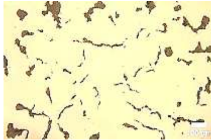
Figure.III.4 Microstructure d'une fonte à graphite vermiculaire
