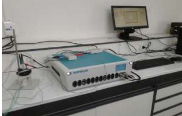
Figure II.6. Montage électrochimique utilisé pour les caractérisations de la corrosion de la fonte à graphite sphoïéridale
