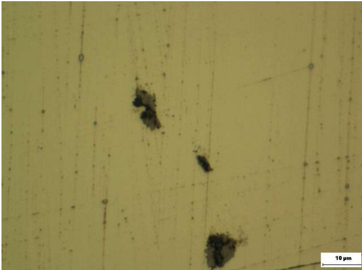
Figure.III.6 details de défauts sur la surface polie et non attaquée de l'échantillon :inclusion d'oxydes
