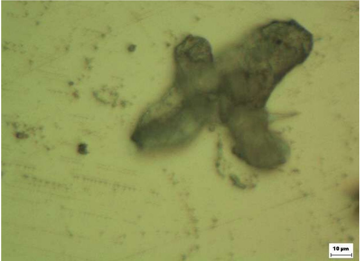
Figure.III.5.details d'une inclusion non metallique :forme de tréfle ,probablement un oxysulfure.
