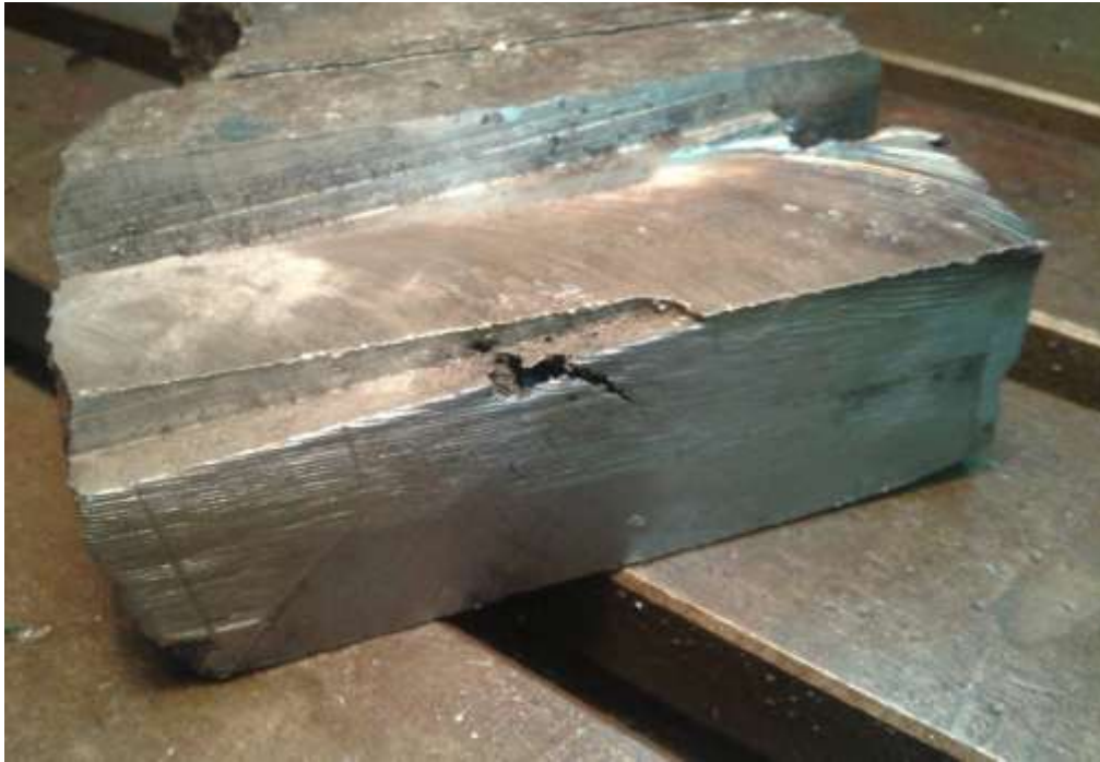
Figure.III.2. macrofissure ayant entraîné la rupture
