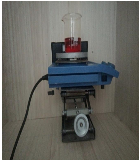
Figure II.8 : Montage expérimental utilisé pour les tests de photodégradation de méthyle orange.
