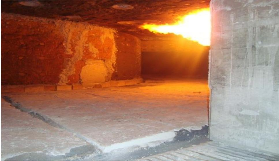
**Figure 1.8.** Intérieur four à sole.
