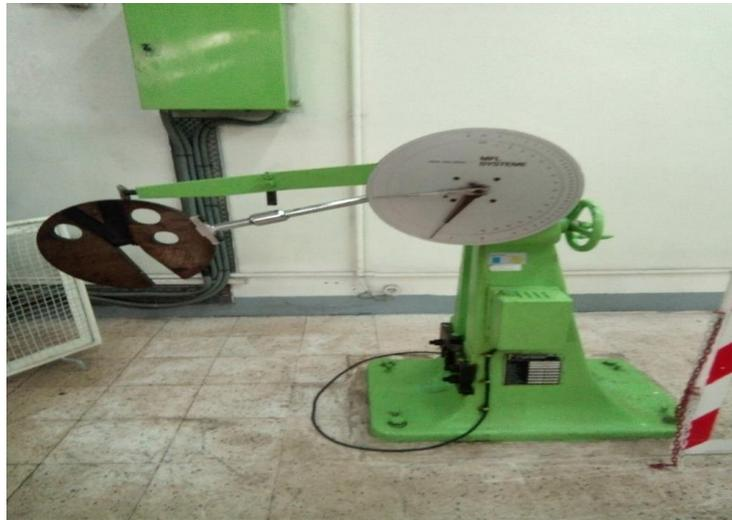
Figure 3.12. Machine de résilience utilisée (laboratoire TSS).
