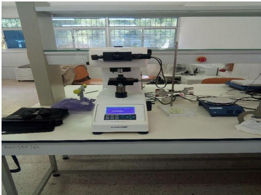
Figure. 3.17. Micro-duromètre type Digital Micro Vickers Hardiness Tester. Model : HVS-1000Z.
