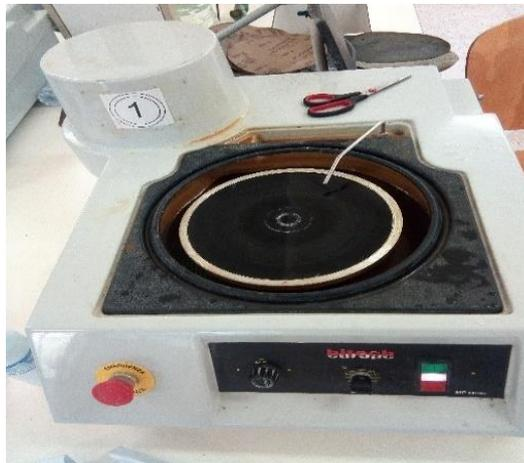
**Figure 3.6.** Polisseuse à vitesse variable.
