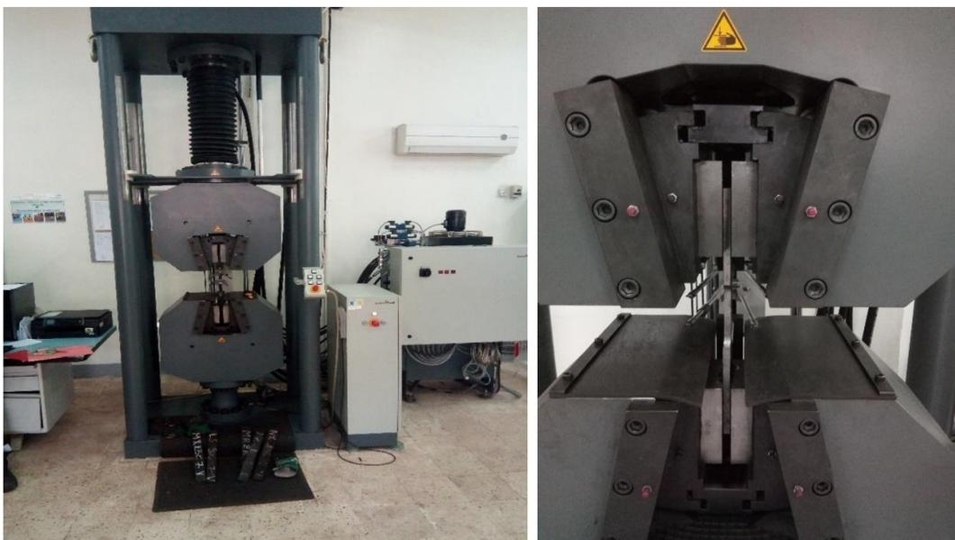
**Figure 3.9.** Machine de traction utilisée de type Zwick BP1-F1200N.F11.
