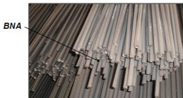
Figure II- 21 : Défaut de barre non alignée.
