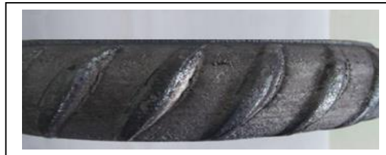
Figure III-33: Aspect macroscopique de l'échantillon E11 après test de pliage.
