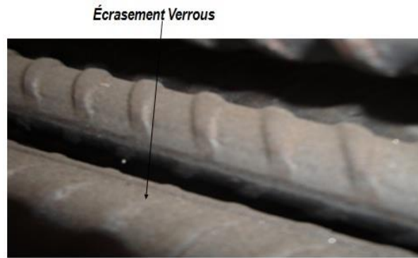
Figure II- 15 : Écrasement de verrous.
