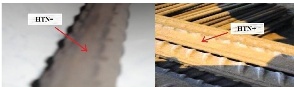
Figure II- 16 : Hors tolérance de nervure.
