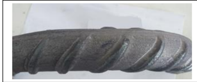
Figure III-8: Aspect de l'échantillon E1 sur la partie pliée.
