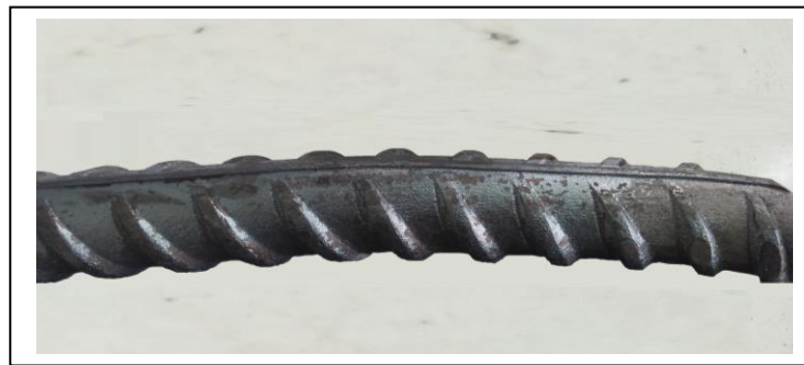
Figure III-12 : Aspect de l'échantillon E3 sur la partie plié.
