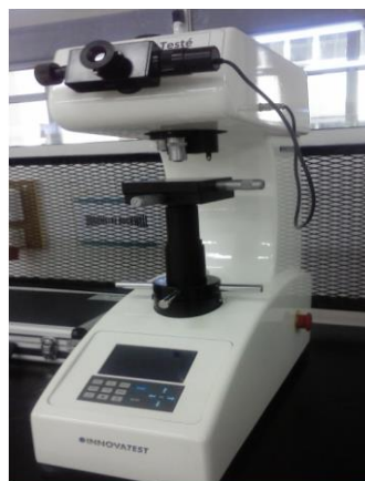
Figure II- 8 : Duromètre universel de type ZWICK- ROELL.
