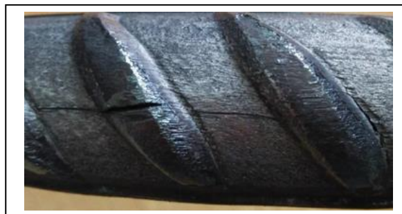
Figure III-18: Aspect de l'échantillon E6 sur la partie pliée.
