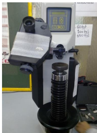
Figure II- 7 : Duromètre universel de type ZWICK- ROELL.
