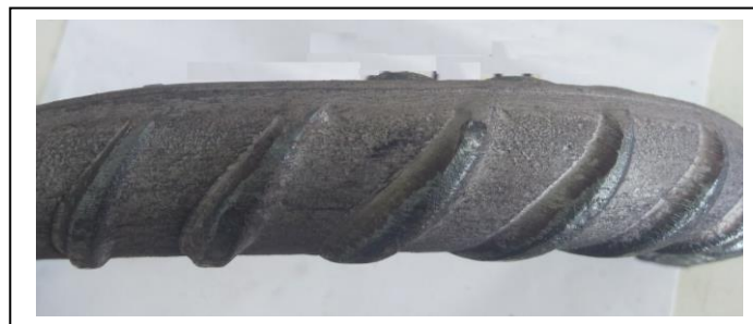
Figure III-10: Aspect de l'échantillon E2 sur la partie pliée.
