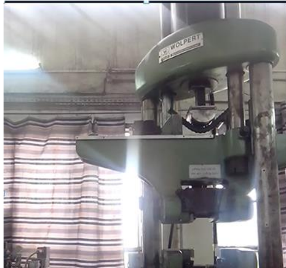
Figure II- 6 : Machine de pliage de type Wolpert.
