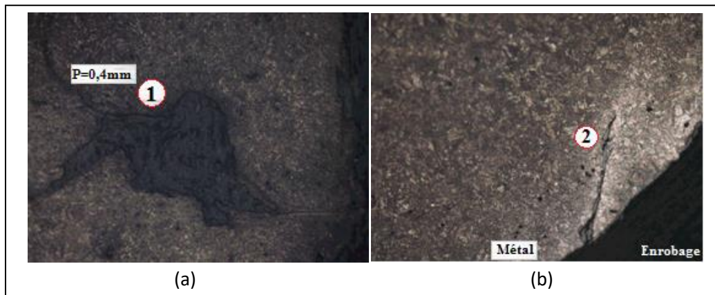
Figure III-44: Micrographie optique des deux fissures apparues sur l'échantillon E13 après attaque chimique. 300X.
