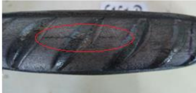
Figure III-25: Aspect macroscopique de l'échantillon E9 après test de pliage.
