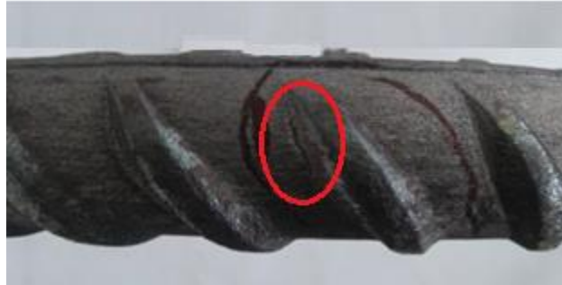
Figure III-41: Aspect macroscopique de l'échantillon E13 après test de pliage.
