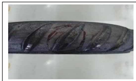
Figure III-29: Aspect macroscopique de l'échantillon E10 après test de pliage.
