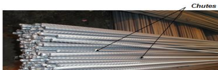
Figure II- 18 : Défaut de chutes.
