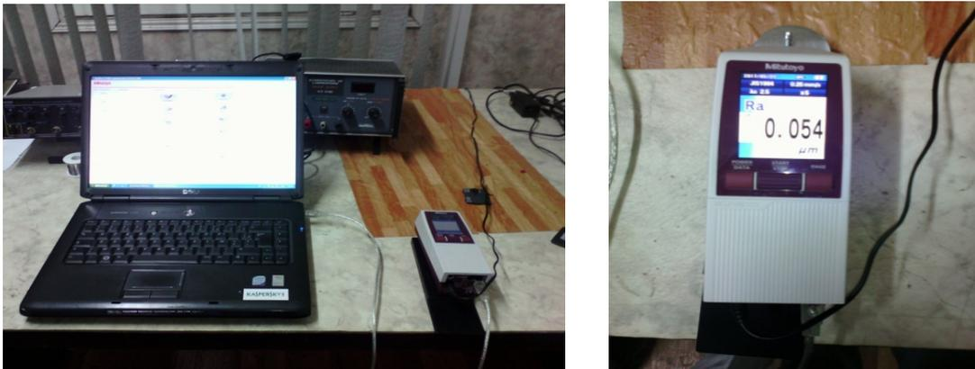
Figure II.4 : Rugosimètre Mitutoyo Surf test SJ-210
