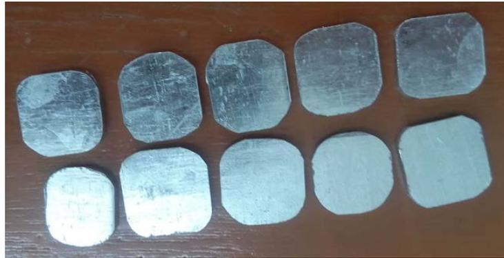
Figure II.8 : échantillons avant l'essai de corrosion.
