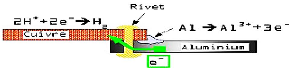
Figure I.3 Corrosion galvanique pour un assemblage de tôles aluminium et cuivre par un rivet sans isolation.
