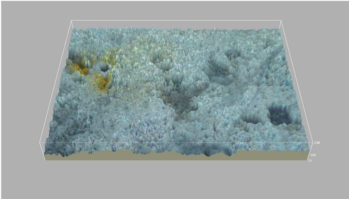
Figure III.5.8: L'état de surface après l'essai de corrosion x50 3D.
