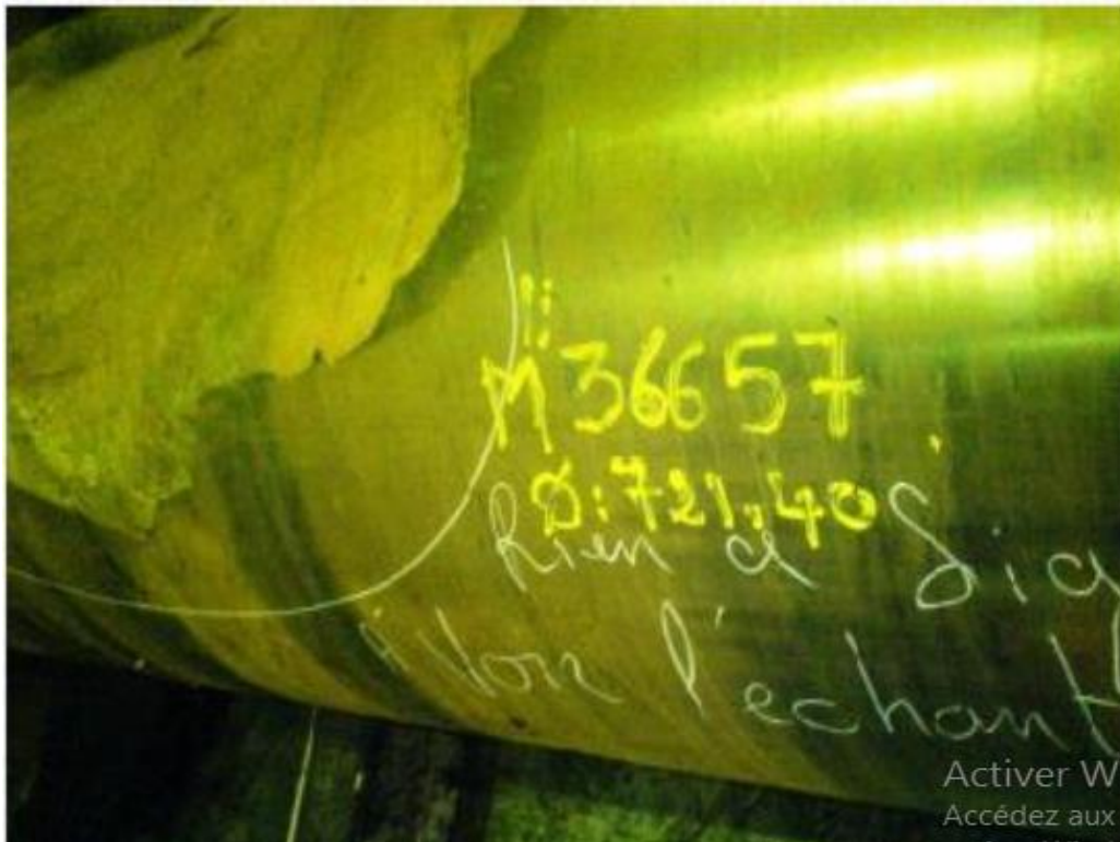
Figure 19 : écaillage sur cylindre N° 36657.
