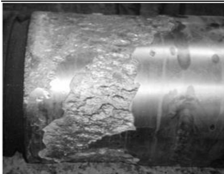
Figure 25 : insuffisance de la profondeur de la couche externe.
