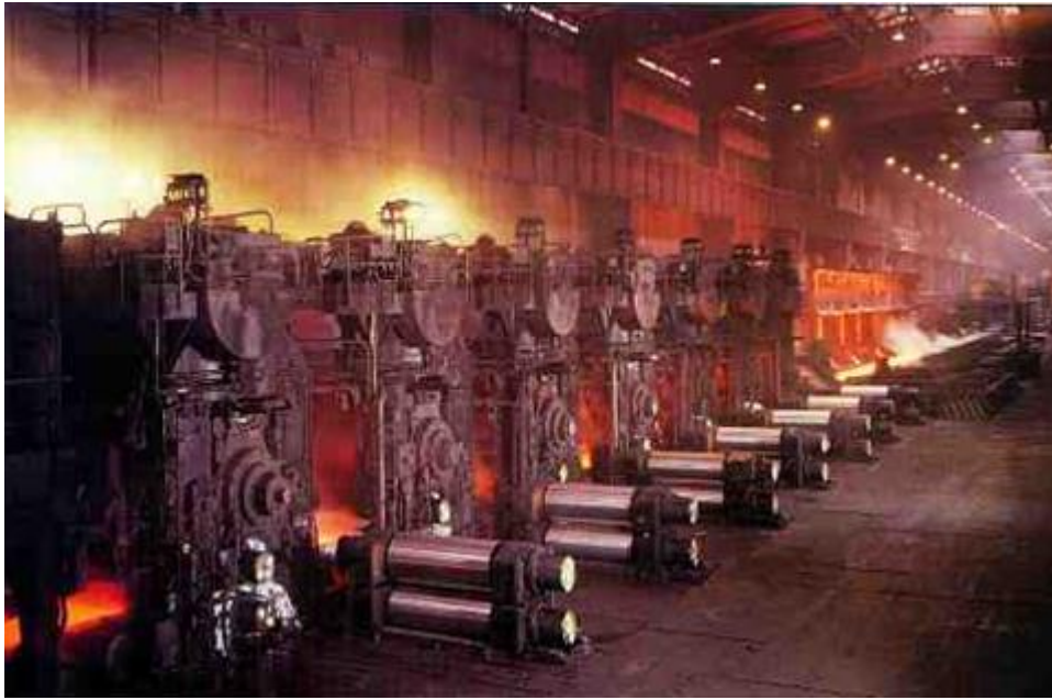
Figure15 : vue des cages finisseuse.
