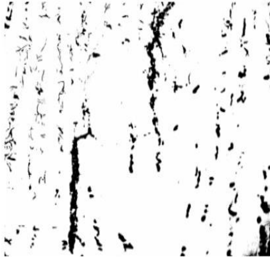
Fig1 : graphite de taille hétérogène G=150x
