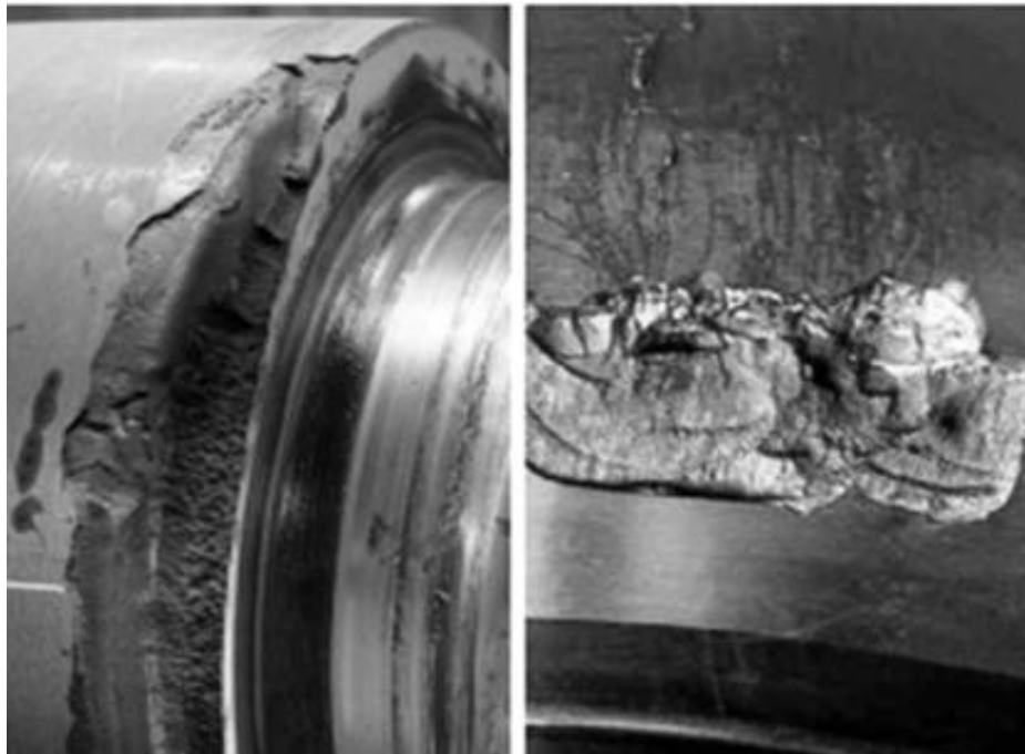
Figure26 : Écaillage des extrémités du cylindre.
