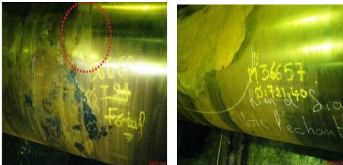
Figure30 : écaillage cylindres MKB.
