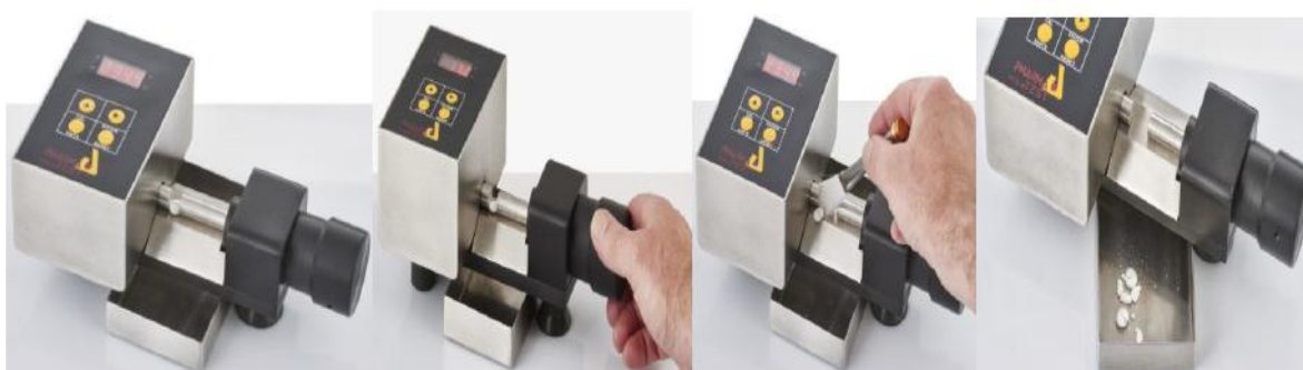
Figure 2.2. Différents étapes de réalisation du test de la dureté
