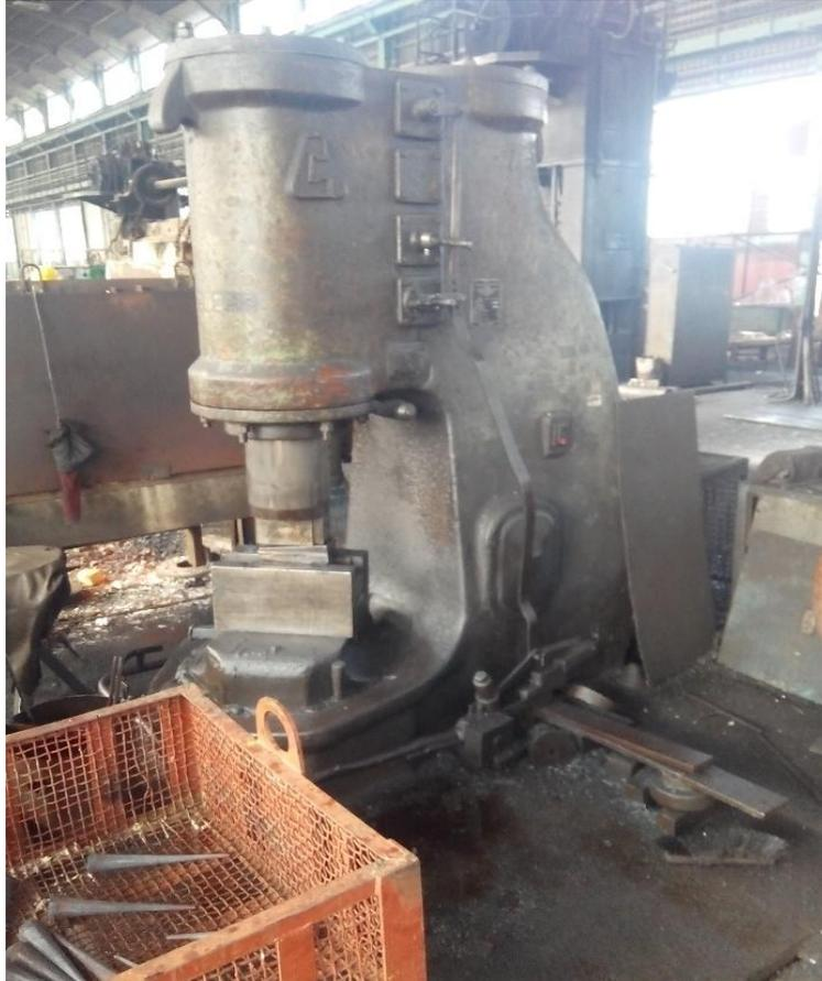
**Figure 23 : Marteau pneumatique**
