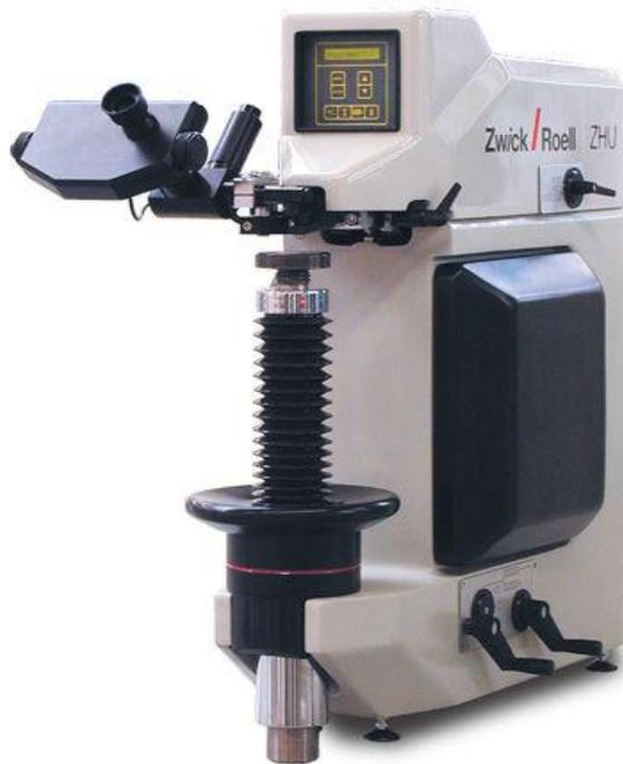
**Figure 35 :Duromètre Zwick Roell ZHU**
