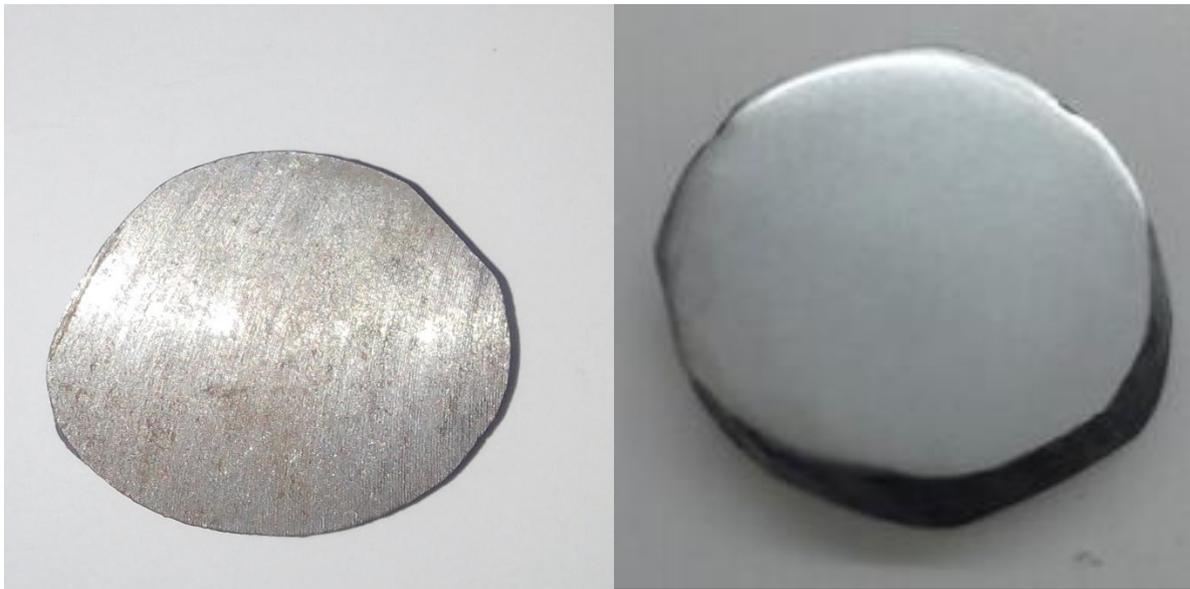
**Figure 32 : Echantillon avant et après polissage**
