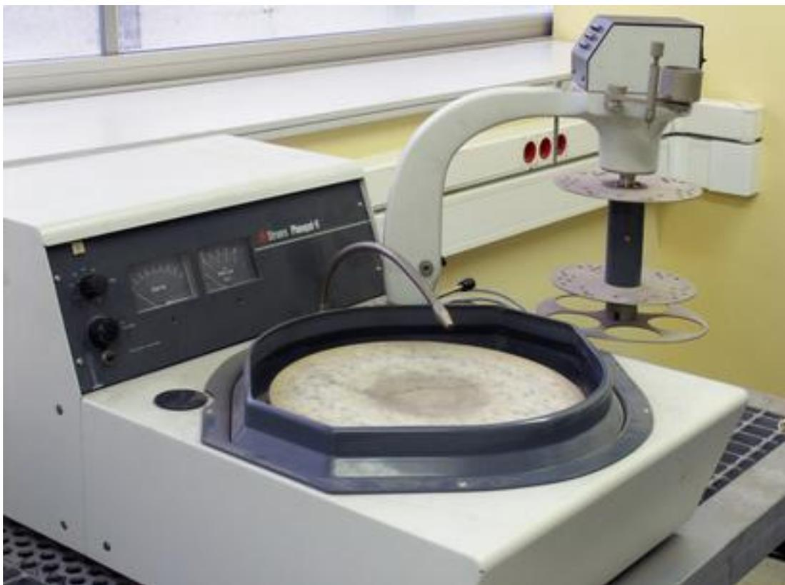
Figure 31 : Machine de polissage Struersplanopol-V
