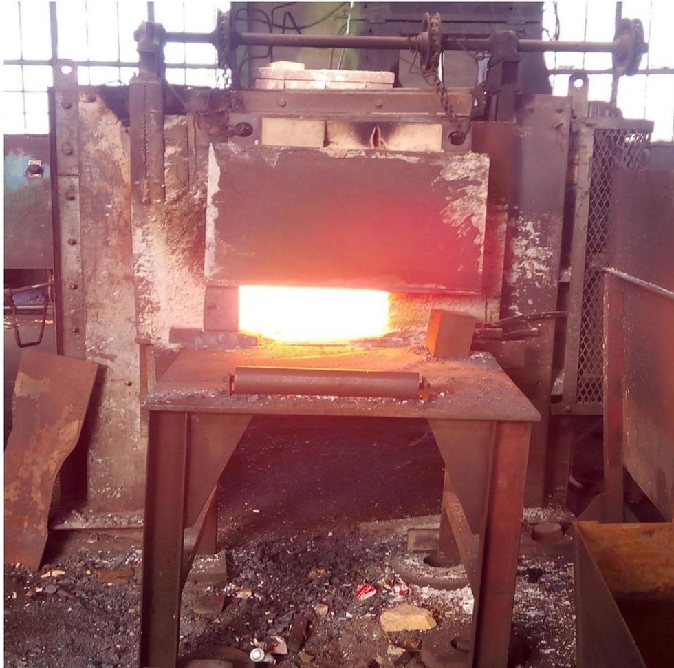
**Figure 22 : Four de forge 150 kg**
