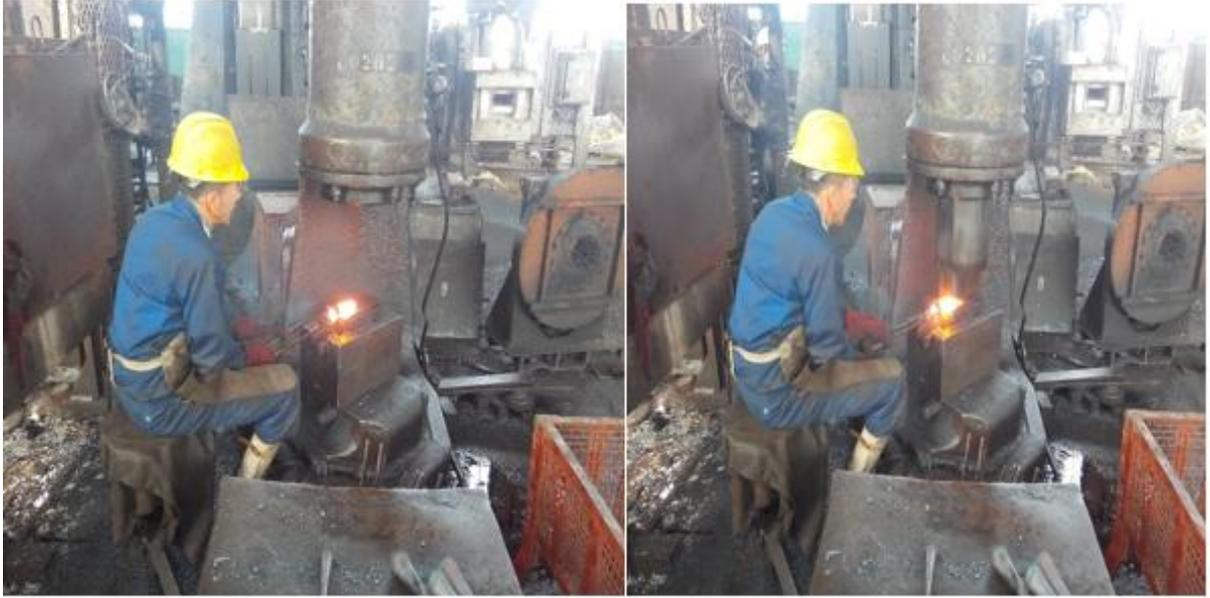
**Figure 27 : Etalonnage de la pièce**
