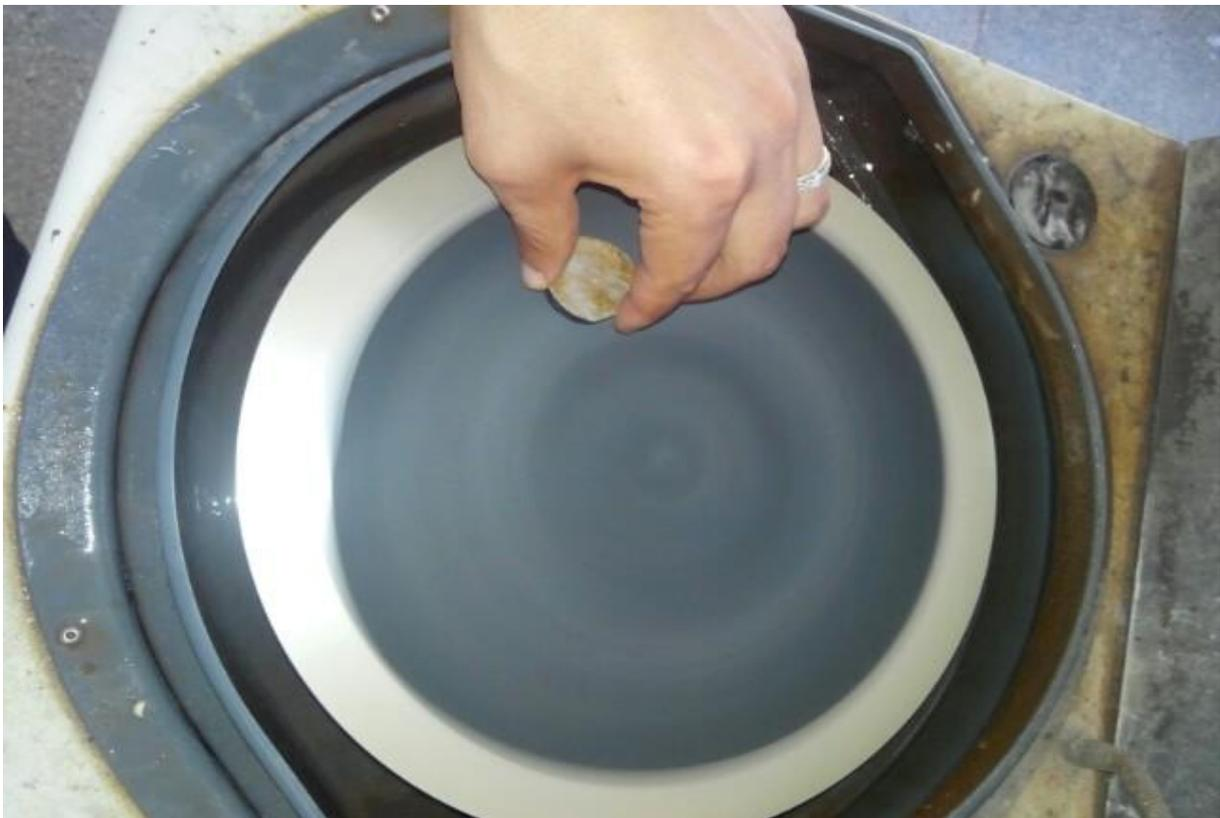
**Figure 32 : polissage de l'échantillon**
