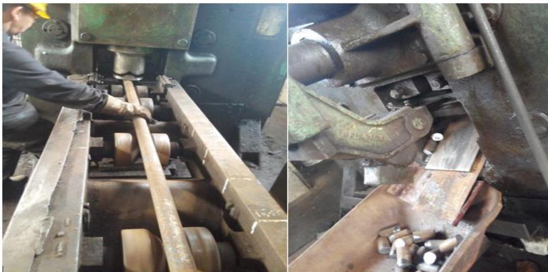
**Figure 25 : Opération de cisaillement**
