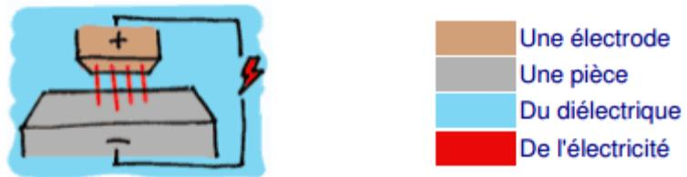
**Figure 18 : Principe de l'électroérosion**
