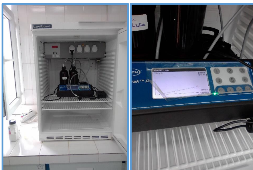
Photographie 3. 3 : Mesure DBO5 avec DBO mètre
