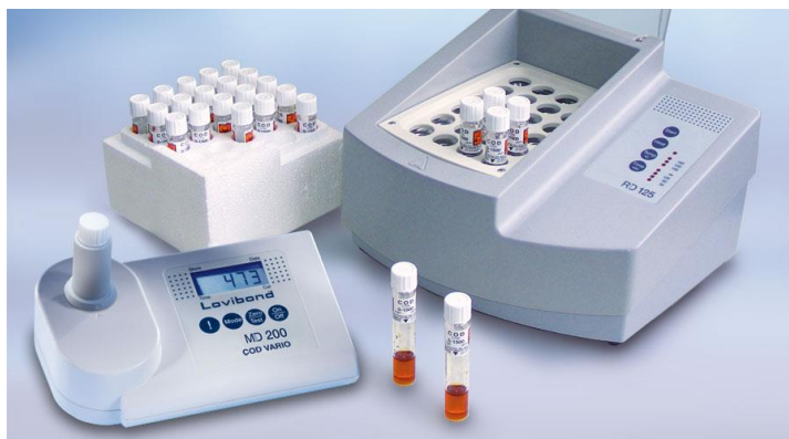
Photographie 3.5 : mesure de la DCO avec spectrophotomètre.
