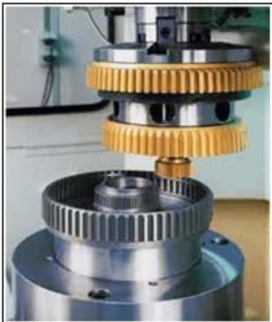
Figure 6 : Taillage des dentures intérieures par outil pignon. [8]
