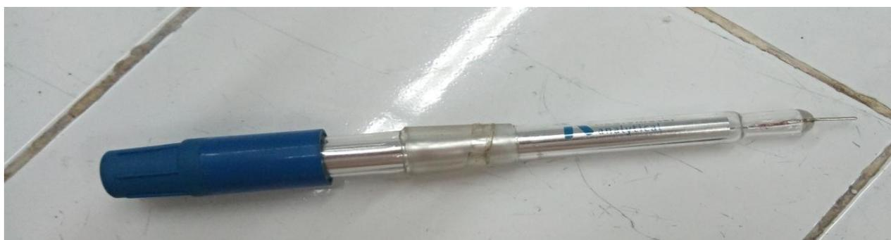
Figure III.2. Electrode auxiliaire
