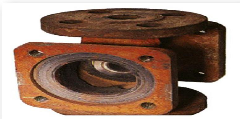
Figure II.4. Corrosion (rouille) d'une pièce en acier
