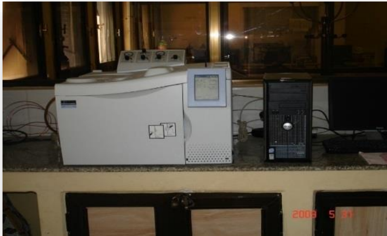
Figure.A01.1. Chromatographe en phase gazeuse pour la détermination de la composition du gaz (gaz naturel ou gaz procès)
