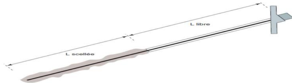
Figure 3.1 : Descriptif simplifié d'un tirant d'ancrage
