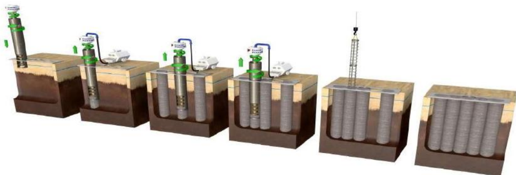
Figure 2.6. Schéma de procédure l'exécution du parois
