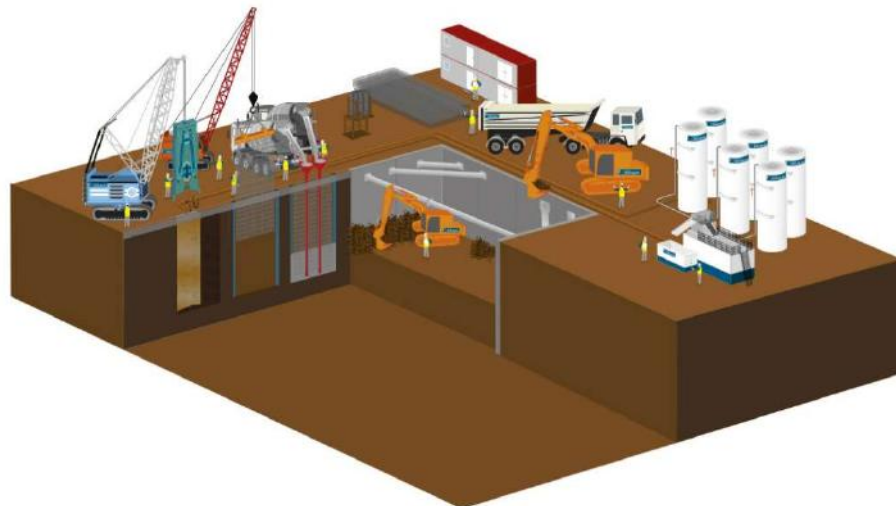
Figure 2.4. Illustration d'un chantier d'exécution du parois moulée
