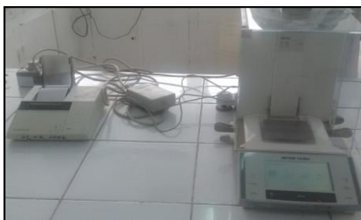
Figure II.20 : Image d'une balance analytique METTLER-TOLEDO®XS 194 avec une imprimante annexe METTLER TOLEDO® utilisé dans laboratoire SAIDAL.
