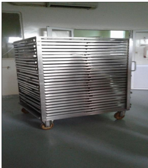
Figure II.5 : Le séchage des poudres de PARALGAN effectué sur un lit en inox
