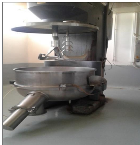
Figure II.4 : L'étape de mélange à l'aide d'un mélangeur granulateur de type « COLETTE »
