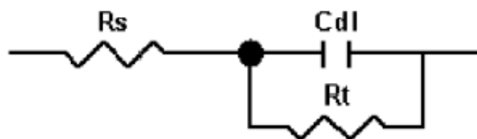
Fig IV.9 : Circuit électrique équivalent de l'interface métal/électrolyte
