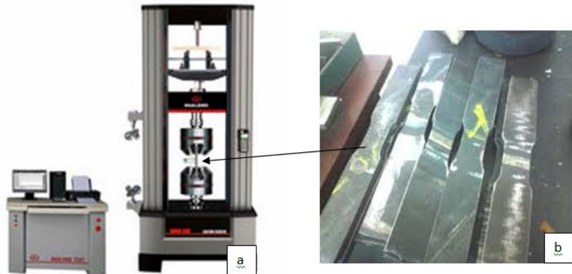
Figure I.5 : a) Machine de traction Type Zwick Roell 300 KN. b) Eprouvette prélevées d'un tube acier En enregistrant la force appliquée à l'éprouvette par la machine de traction et son allongement progressif on obtient un diagramme contrainte-déformation Figure I.6.
