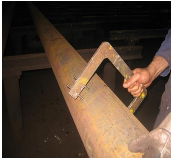
Figure II.2.5 contrôle du diamètre extérieur du tube.
