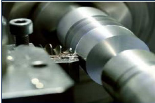
Figure I.39 : opération de tournage. [22]
