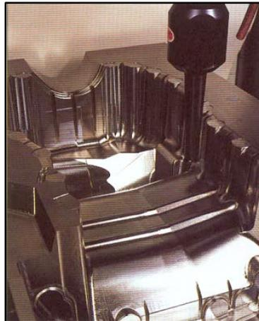
**Figure I.34** : Fraisage d'une matrice. [21]
