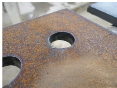
Figure 3 : trou usiné au plasma
