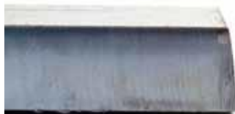
Figure 3.10 : Angle de coupe positive.[12]
