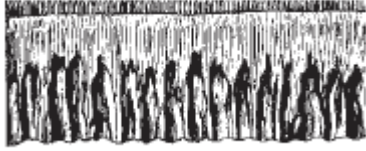
Figure 3.5 : Vitesse d'avance trop faible : fusion de l'arête supérieure. Grosses ondulations irrégulières à la partie inférieure de la saignée. Cause secondaire : pression d'oxygéné de coupe trop basse.
