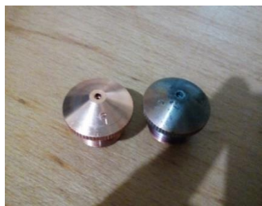
Figure 9,10 : référence entre le composant de la tête (nouvelle tête et une tête détérioré).
