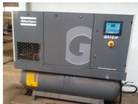
Figure 1.5 : Les compresseurs GA d'atlas Copco
