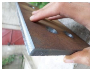
Figure 3 : trou usiné au plasma
