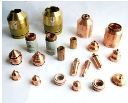
Figure 8 : différents composants de la torche de coupe par plasma
