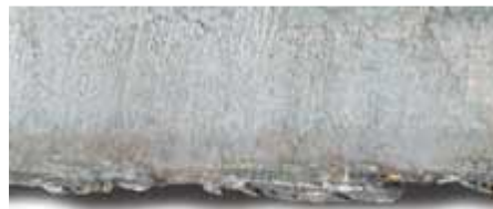
Figure 3.14 : Bavure de vitesse réduite [12]
