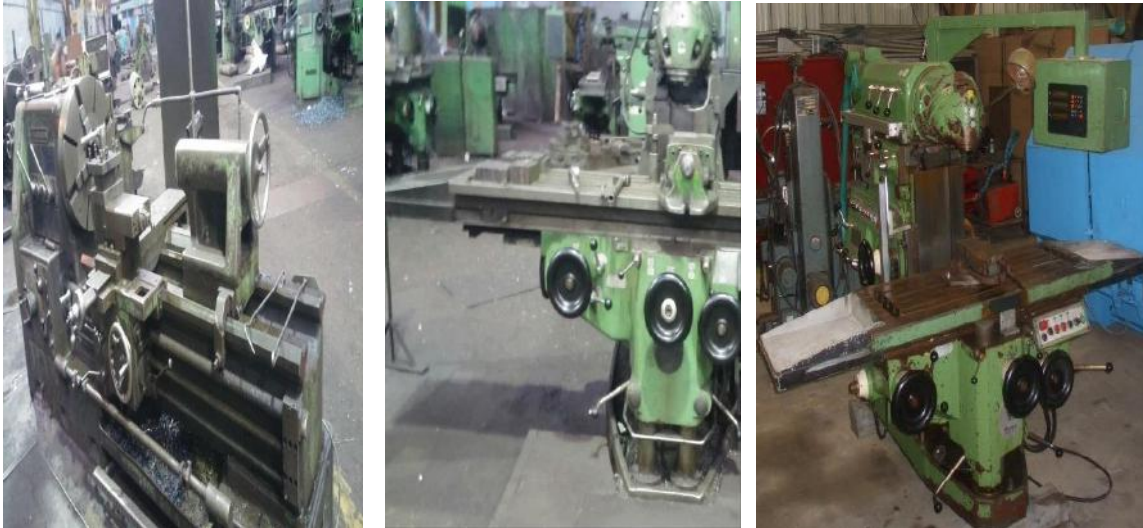
Figure II. 3 Les machines en secteur usinage (tournage, fraisage, perçage).
