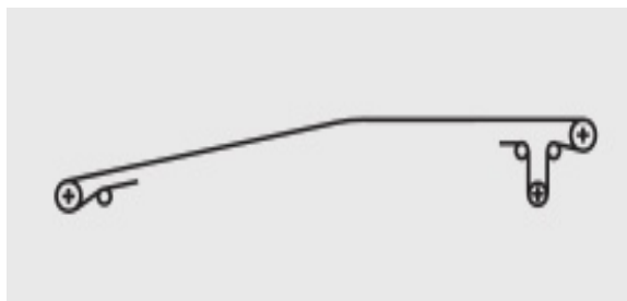
Figure 1.3.e Convoyeur à bande incliné et Tronçon horizontal, où la charge ne nécessite qu'une seule bande et l'espace permet
