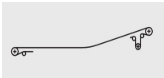
Figure 1.3.c Convoyeur à bande horizontale ou l'espace permet une courbe verticale et la charge ne nécessite qu'une seule bande.
