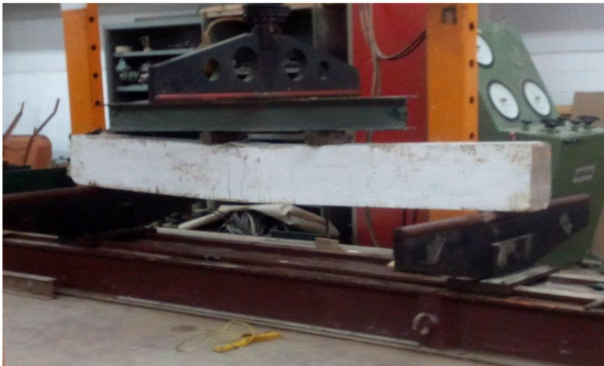
Figure III. 20- Essai de flexion simple
