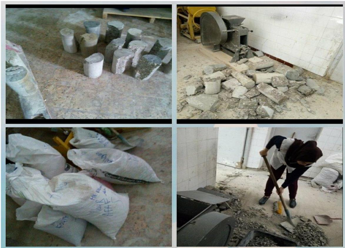
Figure III. 1 -broyage des éprouvettes
