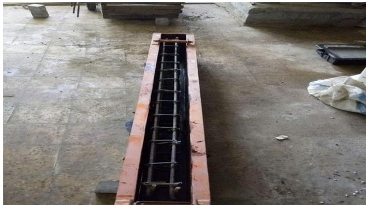
Figure III. 12- mise en place de ferrailage
