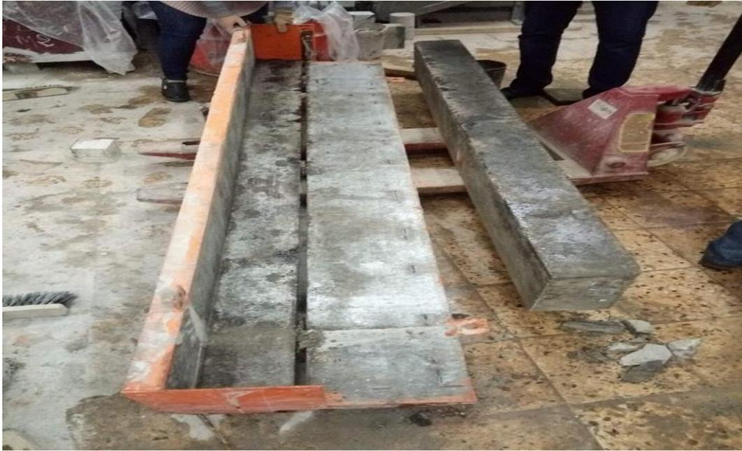
Figure III. 16- démoulage des poutres
