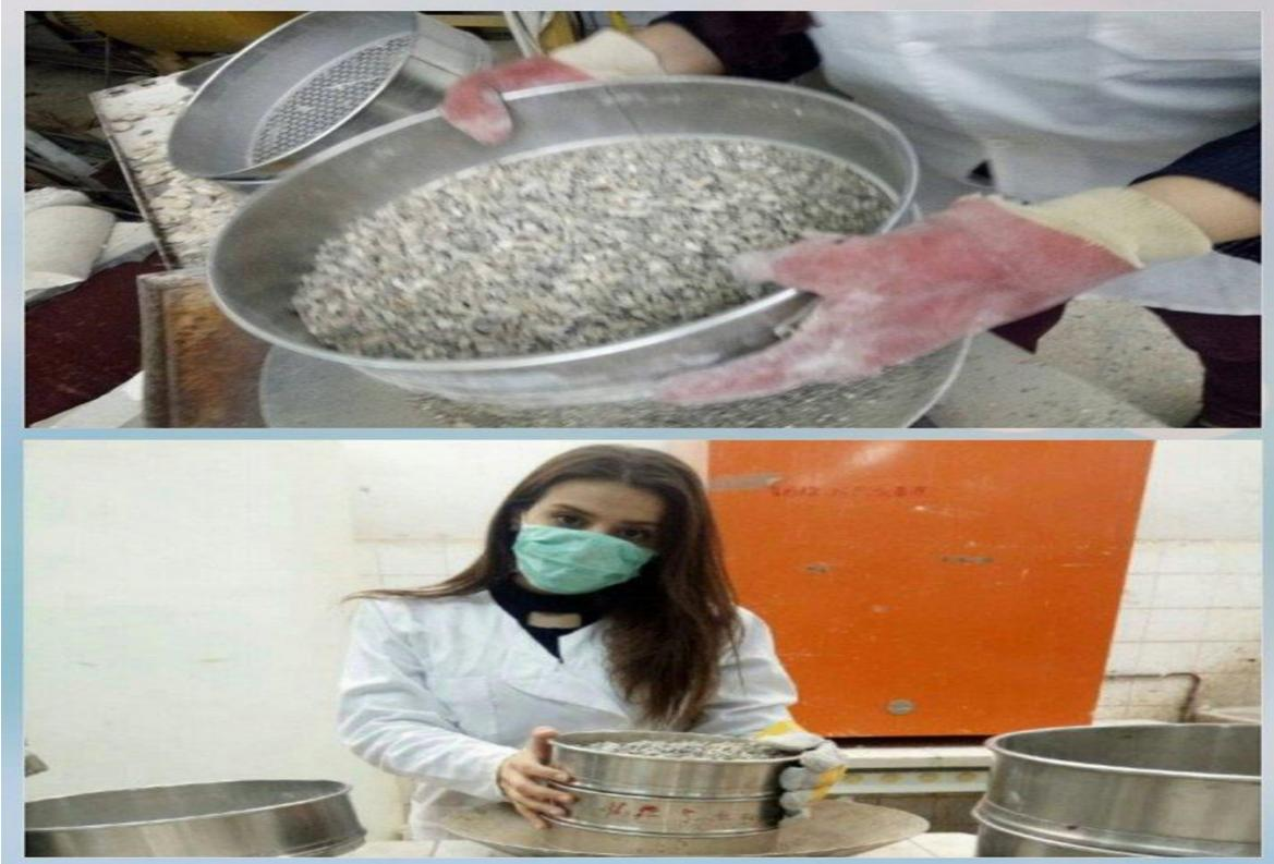
Figure III. 2 - criblages des granulats recyclés
