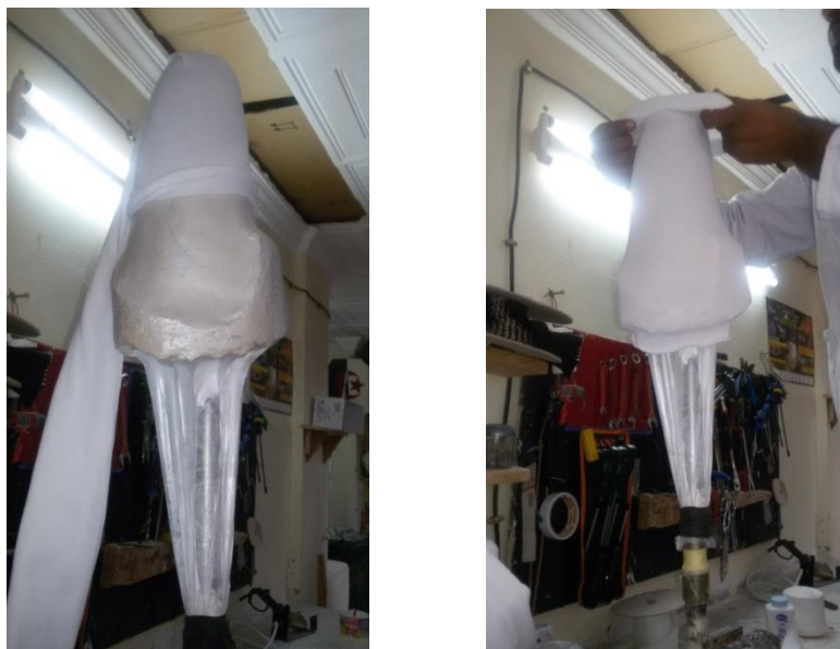
Figure 31: Enfilement du perlon
