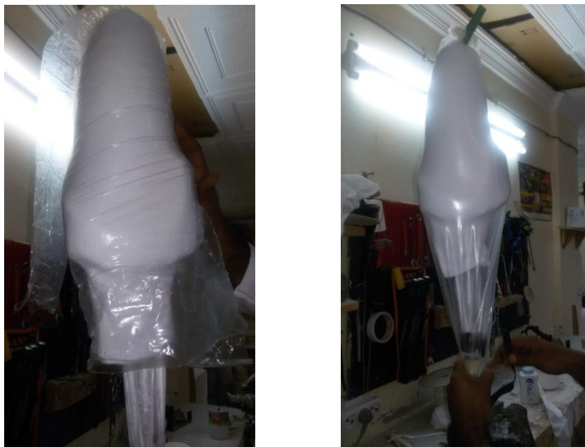
Figure 34 : Enfilement du deuxième film de (PVA)
