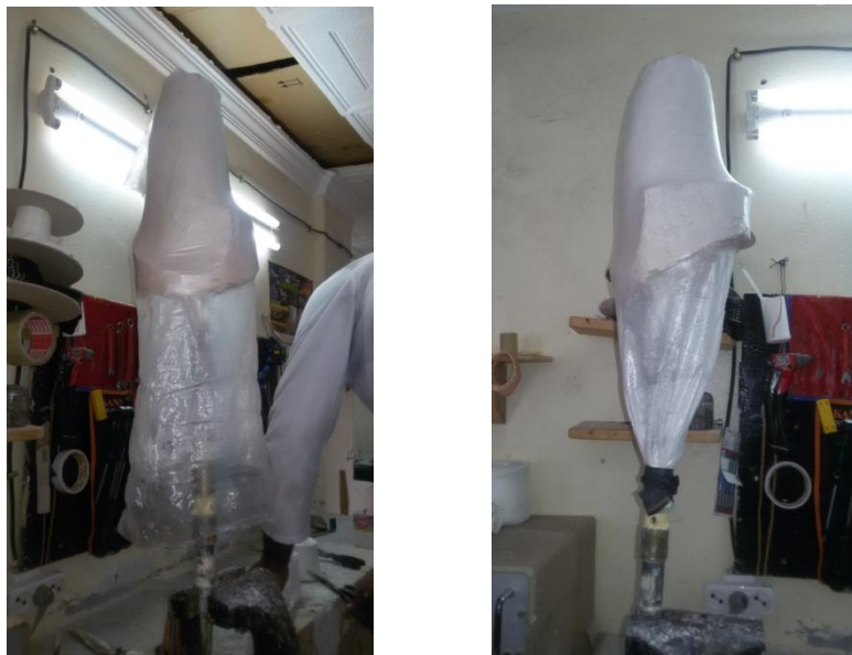
Figure 29 : Etanchéité du film PVA sur le moule
