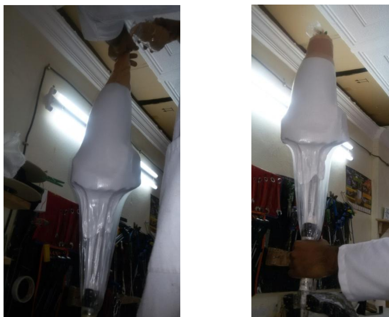
Figure 37 : Imprégnation du mélange à l'intérieur du moule
