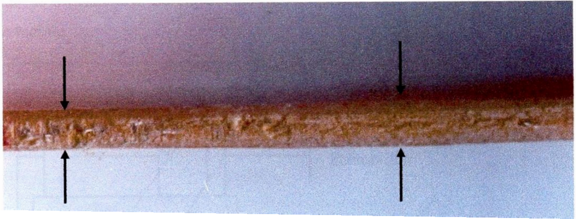
Figure 50 : Irrégularité de l'épaisseur du composite
