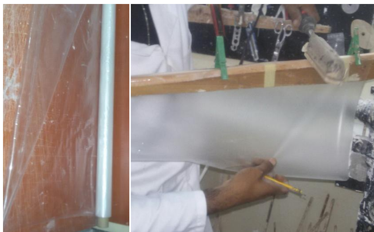
Figure 27 : Préparation du film isolant en (PVA)
