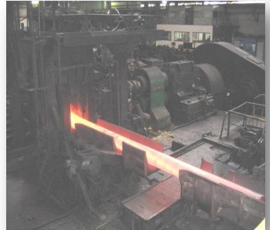
Le laminage consiste à faire allonger et amincir l'ébauche sur un mandrin cylindrique à l'aide de deux cylindres en rotation.
