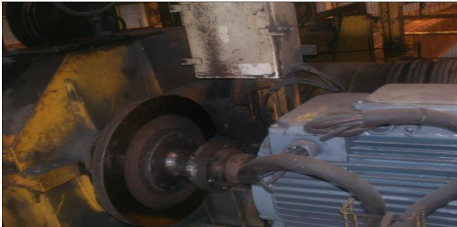
*Figure II.7. Photographie d'un frein à disque*
