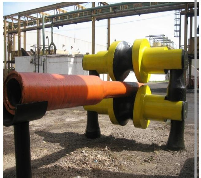
Il y a donc un Mouvement de va et vient de l'ébauche assuré par l'appareil de présentation. L'ensemble de Mouvements constitue un laminoir à pas de pèlerin.
