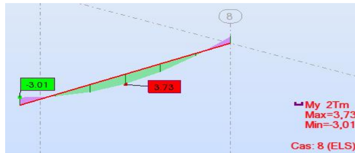
Figure VII.2 : résultats des sollicitations poutres principales à l'ELS (ROBOT AUTODESK)
