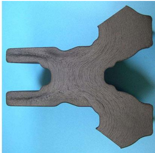
Figure 4. Exemple de fibrage obtenu sur un corps de bielle.
