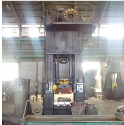
Figure 10 : Presse hydraulique de 400 tonnes
