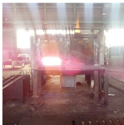
Figure 8 : Chauffage d'un lot de pièces dans le four
