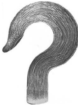
Figure 6. Structure d'une pièce forgée.
