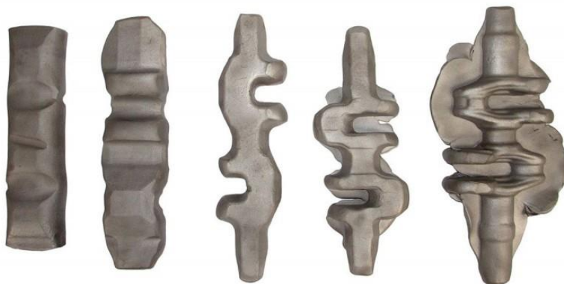
Figure1 : Gamme de forgeage d'un vilebrequin.
