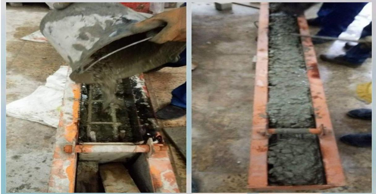
Figure III. 14- la mise en place de béton dans le moule de la poutre
