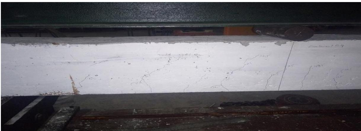
Figure IV.11 : résultats final de la poutre 100% recyclé « écoulement 64KN »
