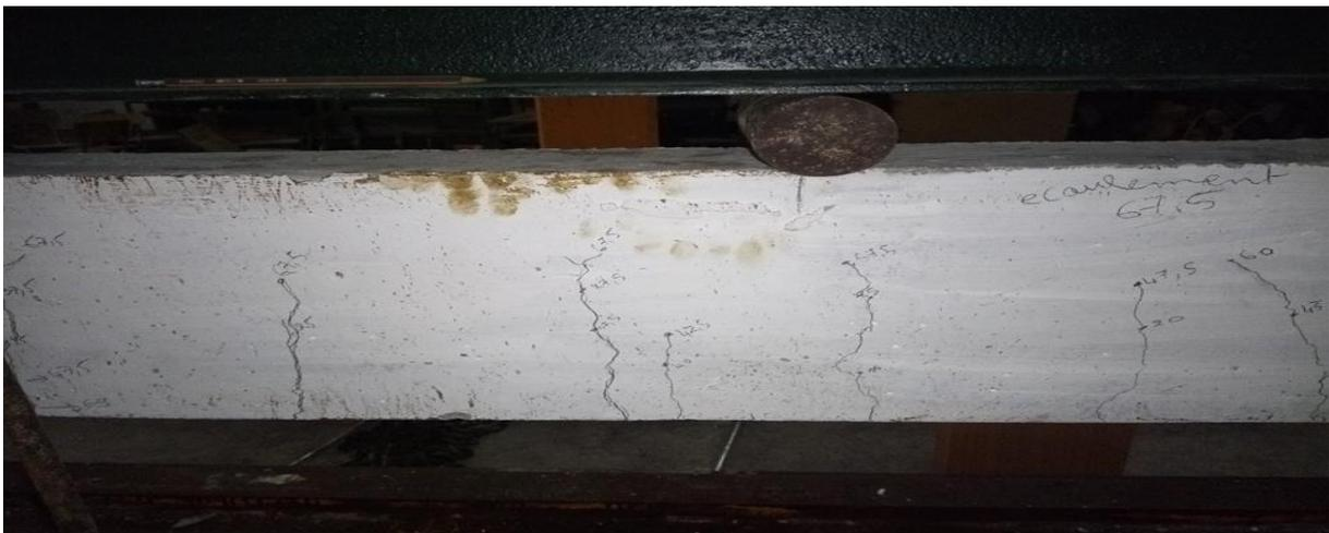
Figure IV.10 : résultats final de la poutre 50% recyclé « écoulement 67.5 KN »
