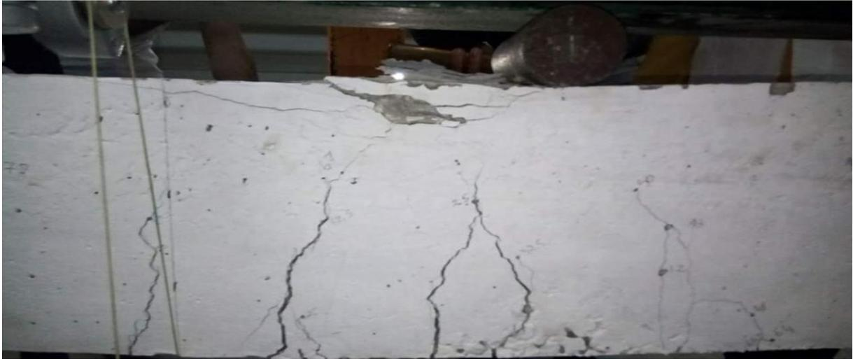
Figure IV.9 : résultats final de la poutre 100% naturel « écoulement 74 KN »
