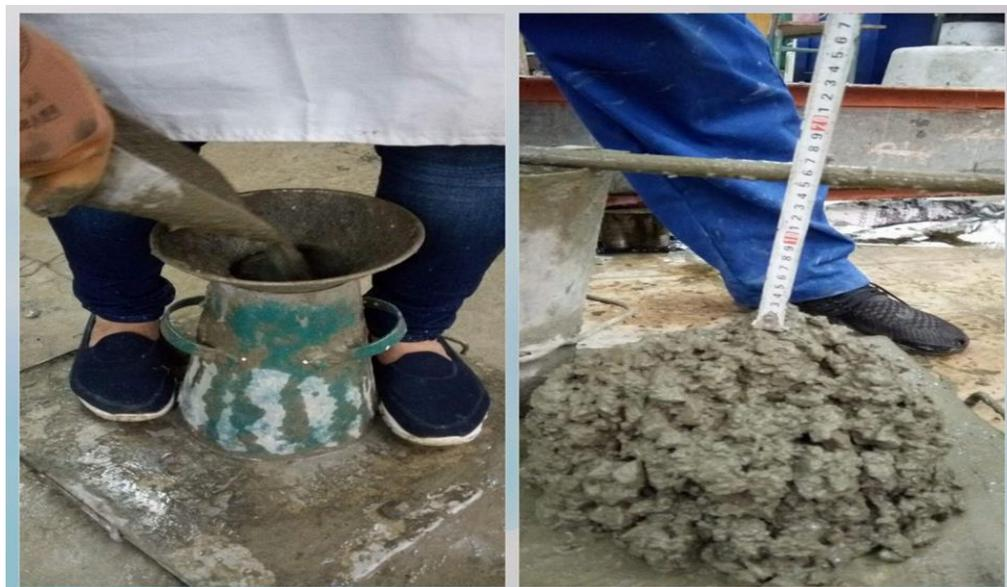
Figure III. 11 - essai d'affaissement au cône d'Abrams
