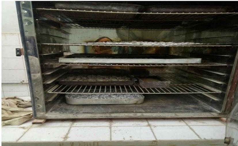
Figure III. 5 - étuve de séchage des éprouvettes
