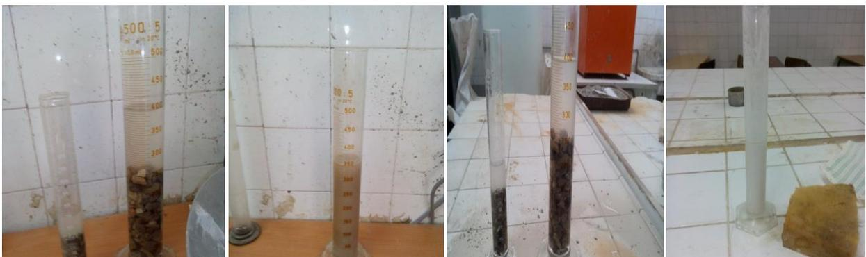
Figure III. 7 - détermination de masse volumique absolue des granulats naturels et recyclé
