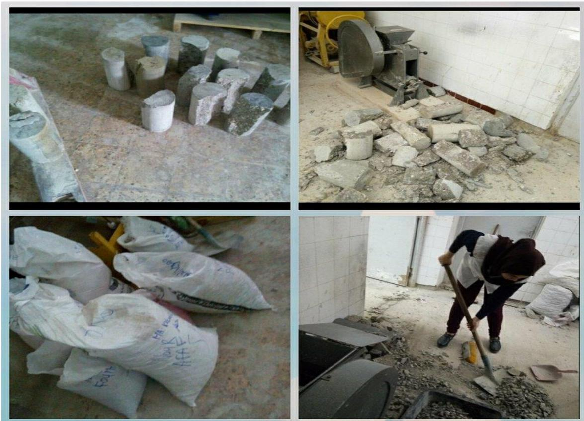
Figure III. 1 -broyage des éprouvettes
