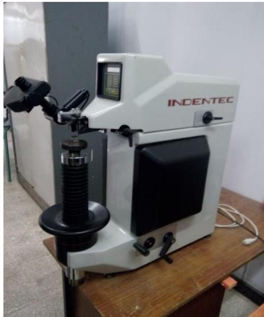
Fig. III.1 : Duromètre indentec
