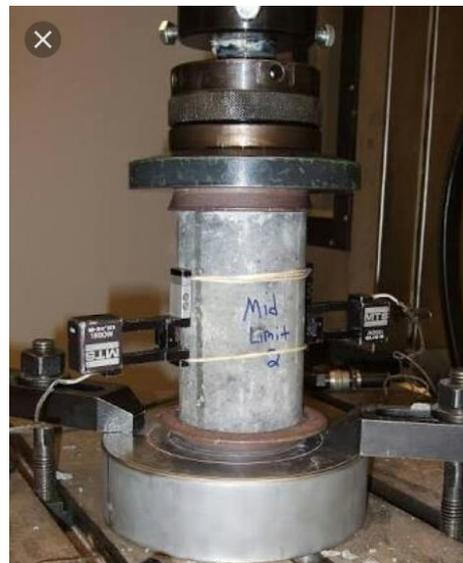
**Fig. I.3** : Essai de compression sur une éprouvette de béton.
