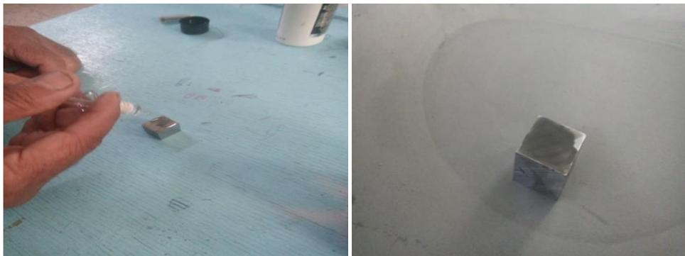
Fig. III.10 L'attaque chimique sur un échantillon d'acier 100Cr6
