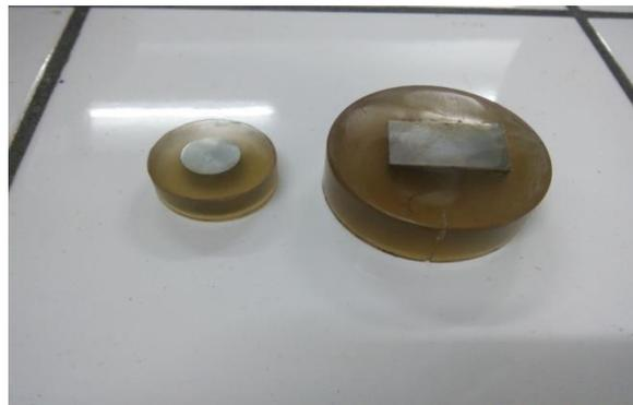
**Fig. III.8** Vue globale de deux échantillons enrobés
