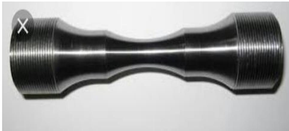
Fig. I.10 vue 3D de l'éprouvette de l'essai de fatigue
