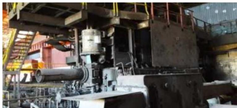
**Figure III.9** cage brise oxyde
