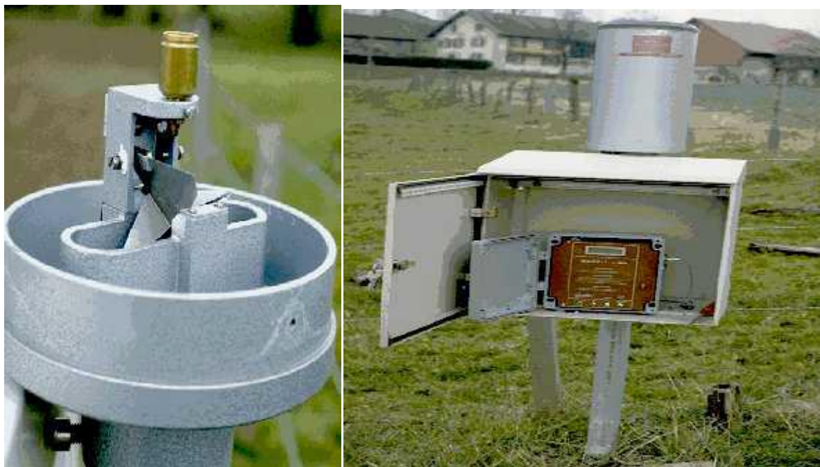
Figure. 15 : Pluviographe, augets basculeurs et système d'enregistrement MADD
