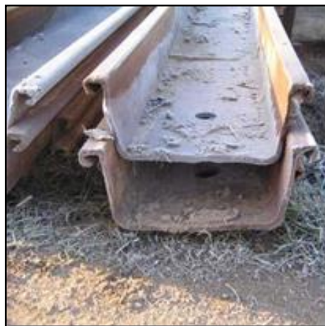
-Figure 5-16 : les palplanches-
