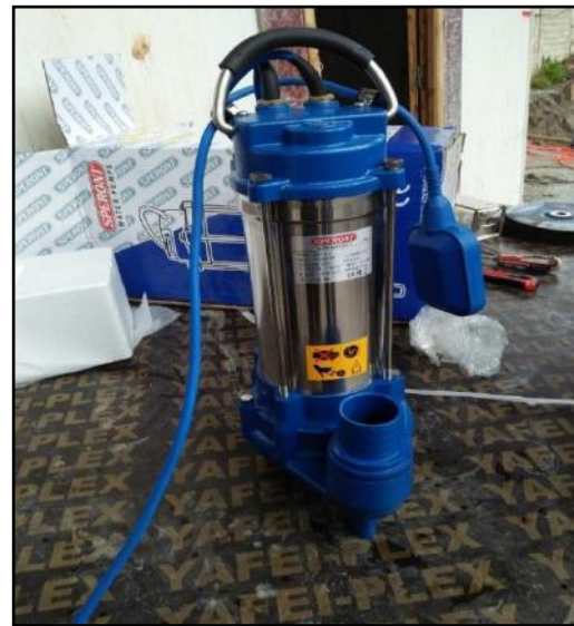
-Figure 5-26 : Pompe immergée-
