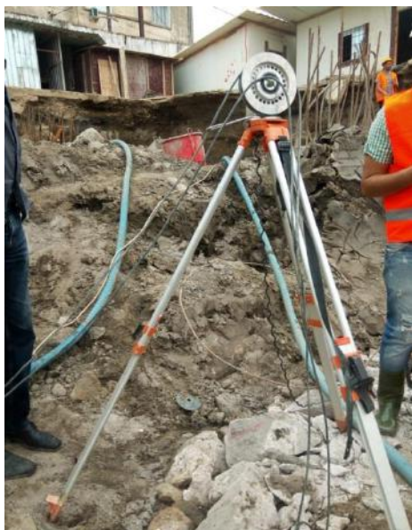
Figure 5-11 : Treuil mesure de profondeur
