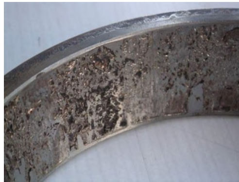
Figure 1.4 Écaillage d'une bague extérieure d'un roulement à rouleaux cylindriques
