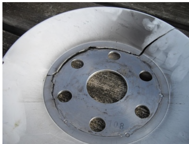
Figure 1.6 Une rupture de la flasque du cône d'hélice
